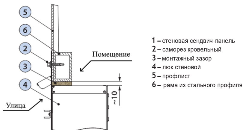
Рисунок 16 – Рекомендуемая схема монтажа вариант 3.4
